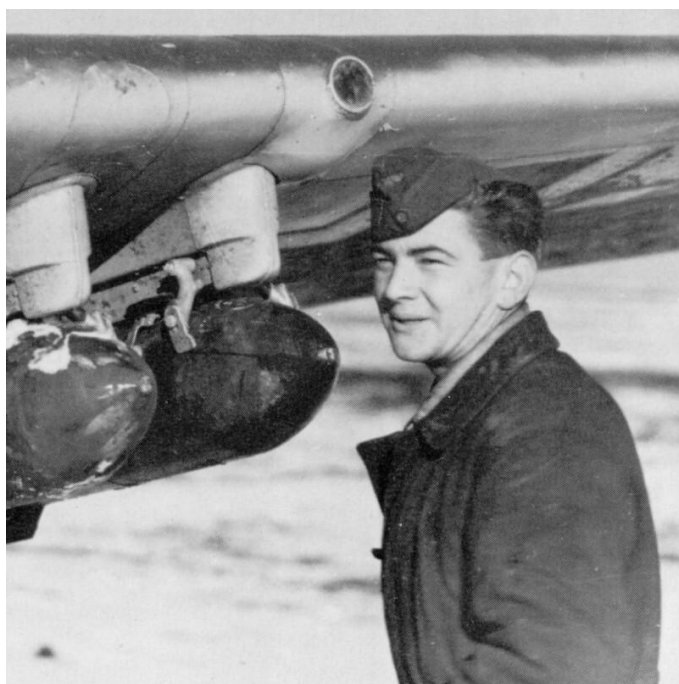
Orifice de protection du Robot II dans le bord d'attaque de l'aile gauche
