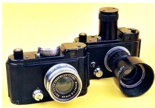
Robot II : appareil embarqué à droite et destiné aux autres départements de la Luftwaffe à gauche
